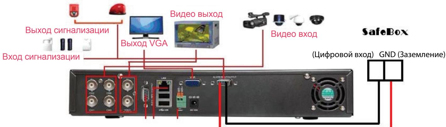
Подключение цифрового видеорегистратора с выходом сигнализации (NCZNO) к DIN и GND в GSM Страж S160.
