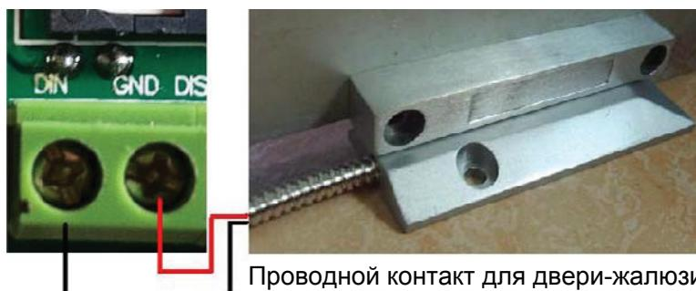
Если вам нужно подключить к GSM Страж S160 более одного проводного датчика, убедитесь, что все проводные датчики имеют один тип выхода (нормально замкнутого или нормально разомкнутого типа), при срабатывании любого из этих датчиков GSM Страж S160 подаст сигнал тревоги.
