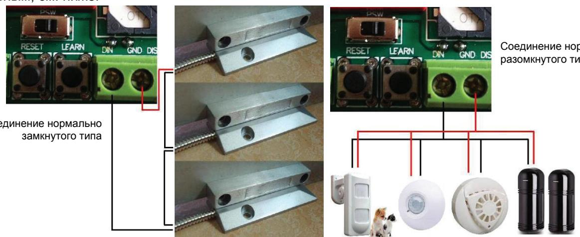
Если проводные датчики - нормально разомкнутого типа, то соединение должно быть параллельным, см. выше.
